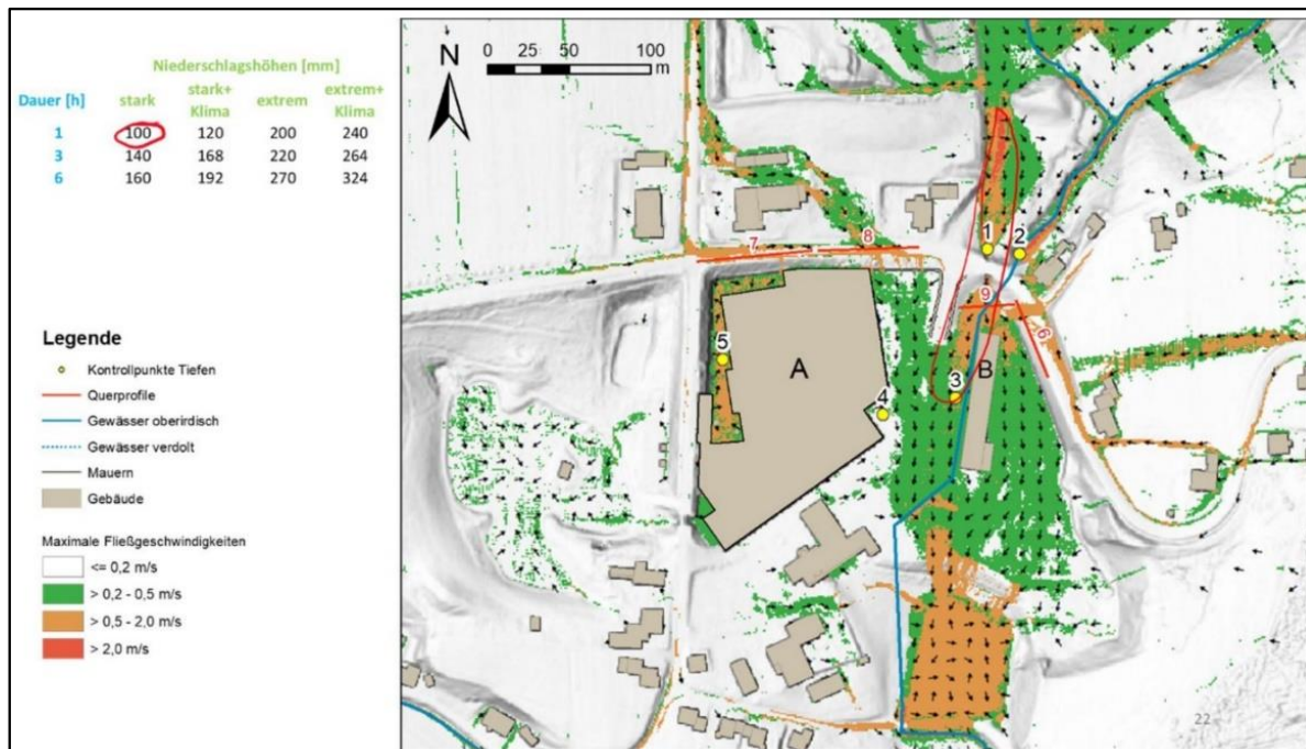
Anhang 6 Abbildung 6: Örtliche Strömungsgeschwindigkeiten für ein Regenereignis mit 100 mm Niederschlagshöhe und der Dauer von 1 Stunde
