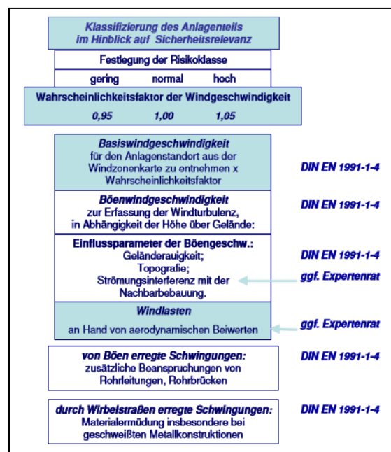
Abbildung 6: Für den Nachweis von baulichen Anlagen zu berücksichtigende Einwirkungen infolge der Gefahrenquelle Wind
