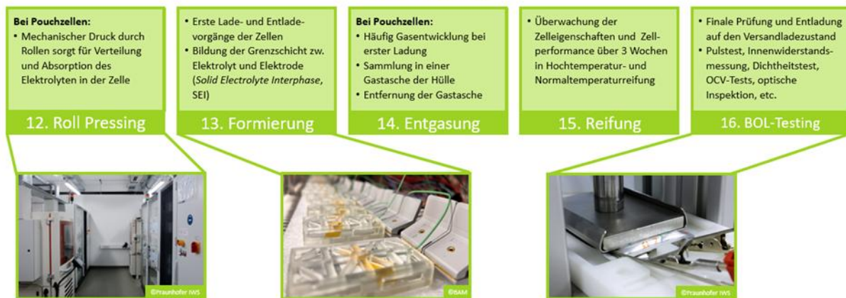
Abbildung 7: Prozessschritte des Zell-Finishing bei der Herstellung einer Lithium-Ionen-Zelle; End of Line Testing (EOL-Testing); (Quelle: BAM, Fotos: Fraunhofer IWS/BAM)
