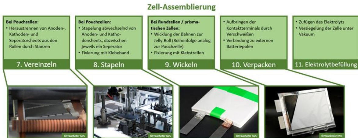
Abbildung 6: Prozessschritte der Zell-Assemblierung bei der Herstellung einer Lithium-Ionen-Zelle (Quelle: BAM, Fotos: Fraunhofer IWS)
