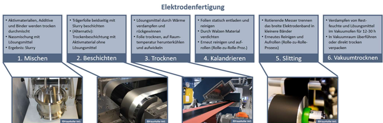
Abbildung 4: Prozessschritte der Elektrodenfertigung bei der Zell-Herstellung (Fotos: Fraunhofer IWS)
