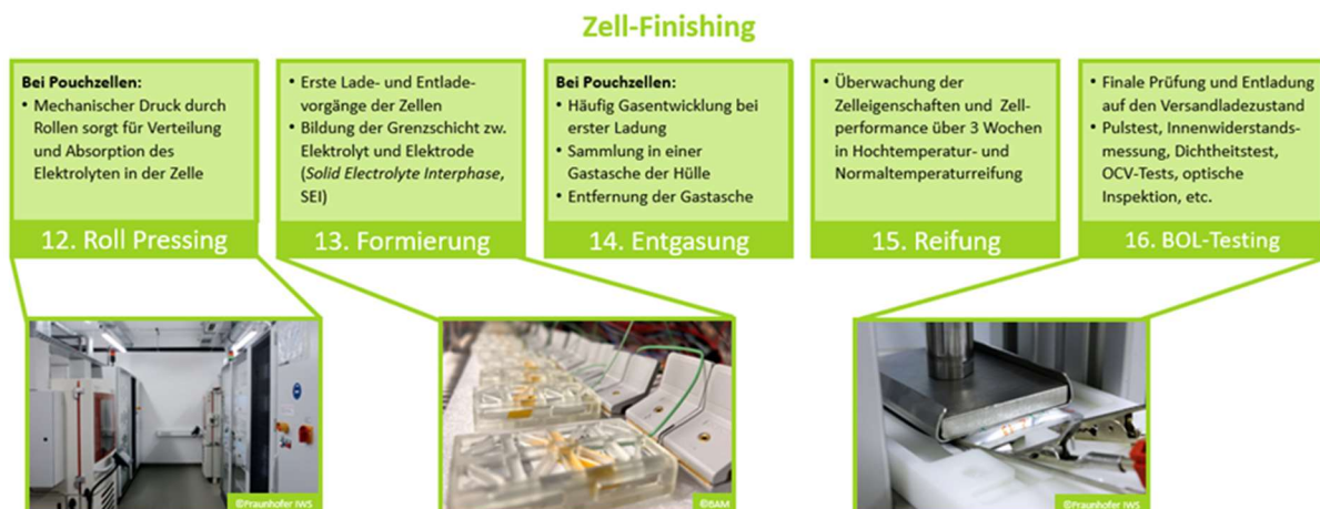
Abbildung 6: Prozessschritte des Zell-Finishing bei der Herstellung einer Lithium-Ionen-Zelle; End of Line Testing (EOL-Testing); (Fotos: Fraunhofer IWS/BAM)
