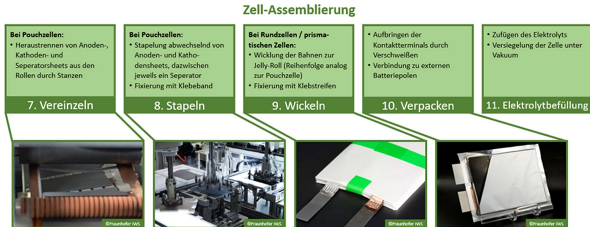
Abbildung 5: Prozessschritte der Zell-Assemblierung bei der Herstellung einer Lithium-Ionen-Zelle (Fotos: Fraunhofer IWS)
