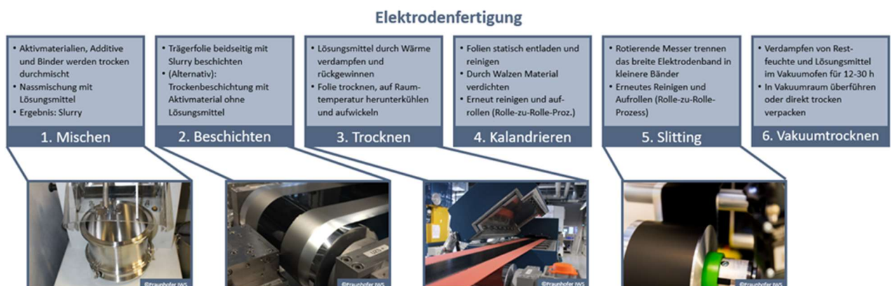
Abbildung 5: Prozessschritte der Elektrodenfertigung bei der Zell-Herstellung (Quelle: BAM, Fotos: Fraunhofer IWS)
